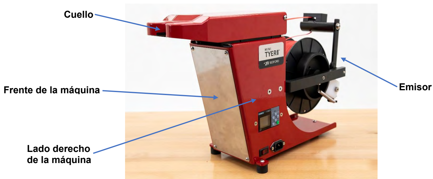
Figura 1.2.1 Vista de la Bedford Mini Tyer™ Pro
